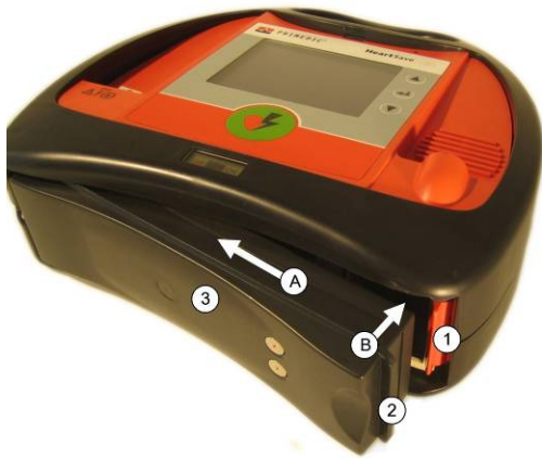
Abb. 10: Einlegen des Energiemoduls
