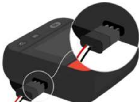
Abb. 7 Elektrodenstecker mit Elektroden an das Gerät anschließen
